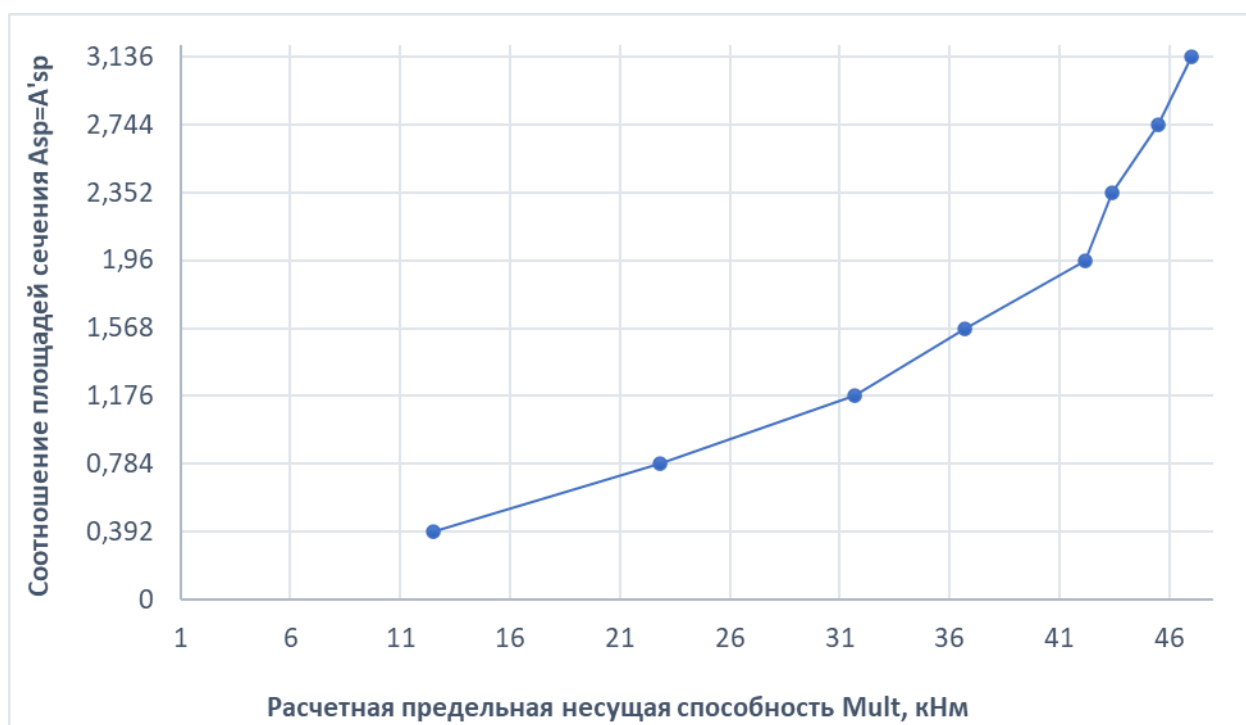
Рисунок 2. График зависимости изменения M_{ult} при увеличении количества арматуры для схемы симметричного армирования A_{sp} = A'_{sp}
